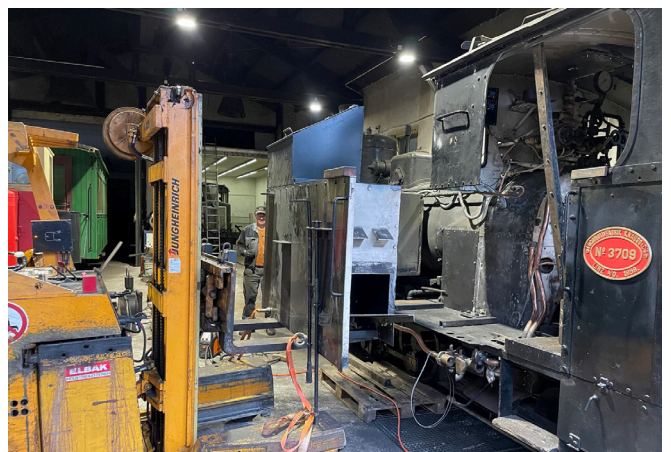
Am 10. Juni 2023 wird der Kohlekasten der Dampflok U.I mithilfe des Elektrostaplers im Heizhaus in Kienberg montiert. Foto: Michael Kaltenecker
