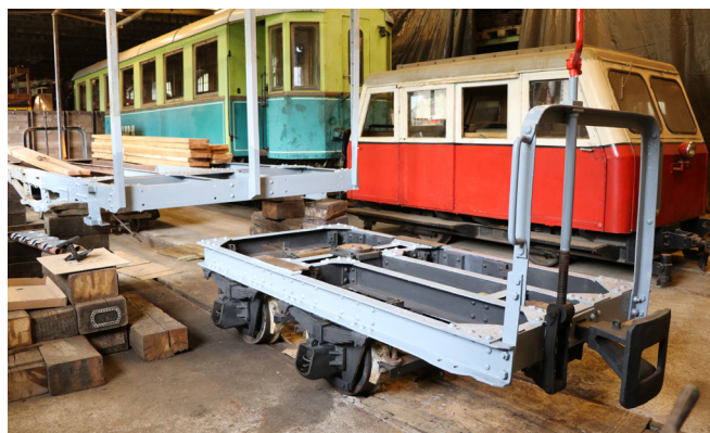
Das erste Drehgestell des Güterwagens Owa 321 ist bereits fertig lackiert, der Rahmen teilweise. Foto: Ferdinand Drexler, Hirschwang, 23. April 2023
