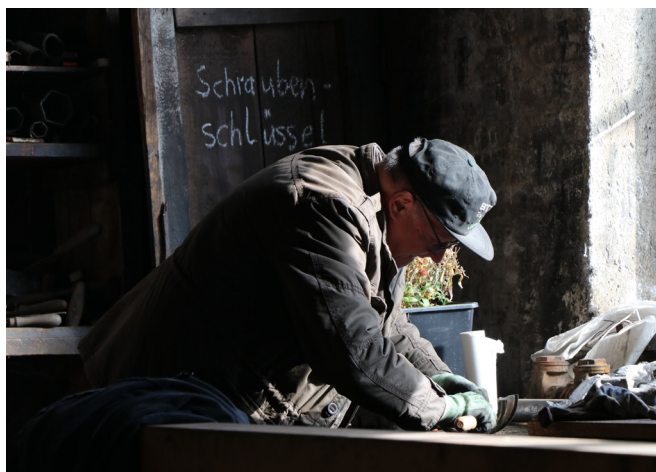
Ferdinand Losbichler beim Ausschaben der neuen Achslagerschalen der Diesellok V 2. Foto: Ferdinand Drexler, Hirschwang, 5. Februar 2023.
