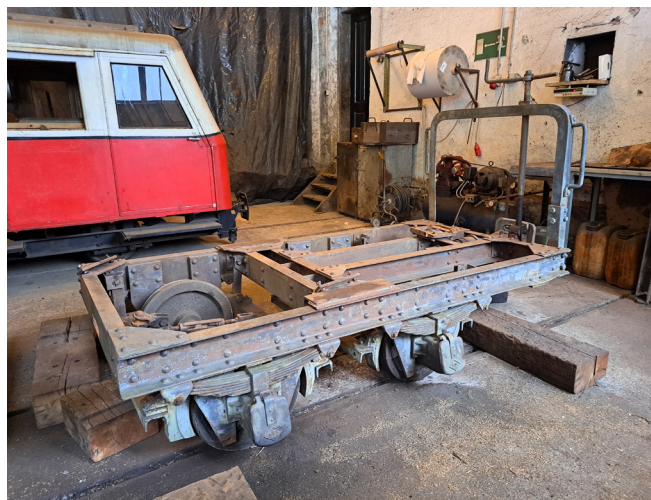
Das erste von den beiden Drehgestellen des originalen L.B.P.-H.-Güterwagens Owa321 ist bereits entrostet und ist für die Grundierung vorbereitet. Foto: Ferdinand Drexler, 28. Jänner 2023
