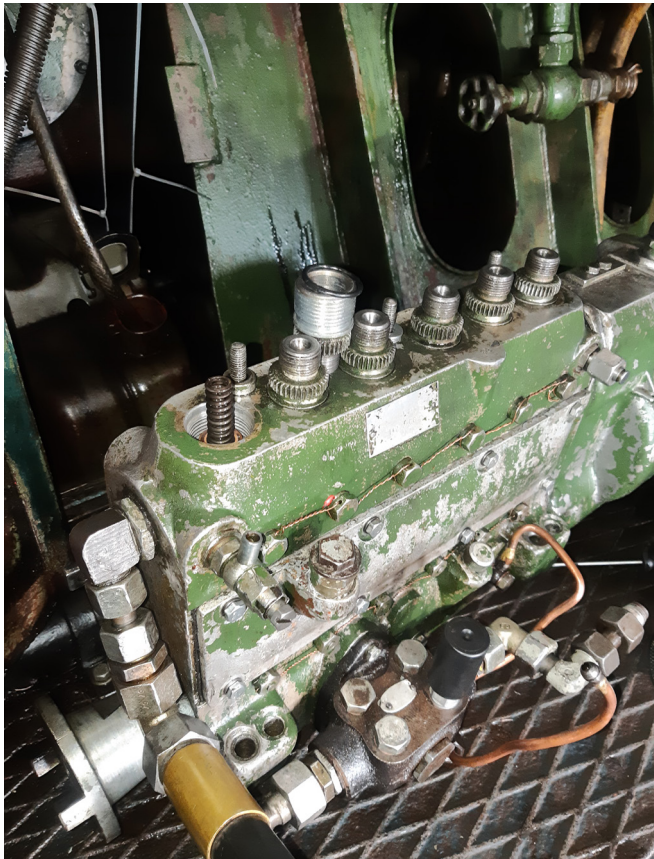
Die teilweise zerlegte Einspritzpumpe der Diesellokomotive 2099.01. Foto: Stephan Rewitzer, 27. November 2022
