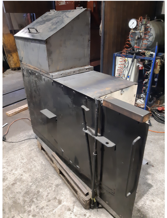
Am 1. November 2022 ist der Neubau des Kohlekastens bereits fertiggestellt und wartet nur mehr auf seinen Anstrich und Einbau. Foto: Stephan Rewitzer
