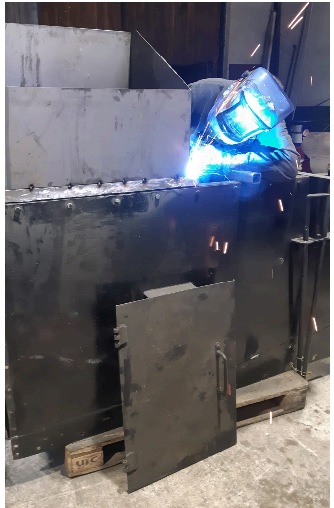
Thomas Edlinger schweißt am Kohlekastenaufsatz der Dampflokomotive U.I. Foto: Stephan Rewitzer.
