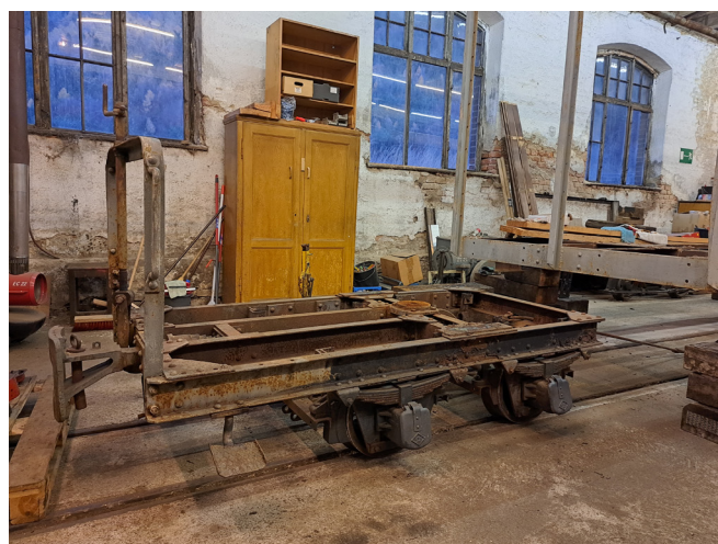
Das ausgebaute Drehgestell mit Bremserbühne des Güterwagens Owa 321, rechts am Bildrand ist der Wagenkasten zu erkennen. Hirschwang, 26. November, Foto: Ferdinand Drexler
