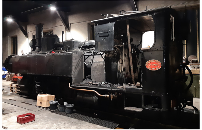
Die Dampflokomotive U.1 mit demontiertem Kohlenkasten im Heizhaus in Kienberg-Gaming. Foto: Stephan Rewitzer
