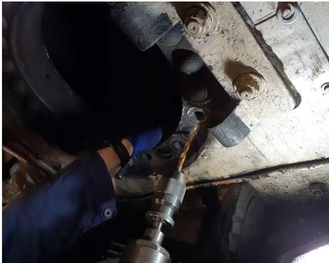
Aufbohren der Nieten an der Außenseite. Foto: Stephan Rewitzer
