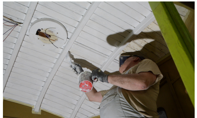
Am 4. Juni grundiert Albert Malli die Decke des Beiwagen Nr. II. Foto: Albin Michlmayr
