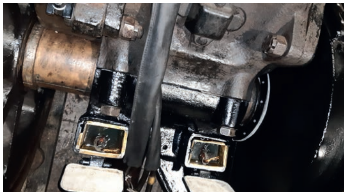
Der neue Schutz der Fahrmotorkabel aus Leder, die aufgearbeitete Tatzlagerschmierung und die montierten Großrad-Lagerkästen. Foto: Stephan Rewitzer
