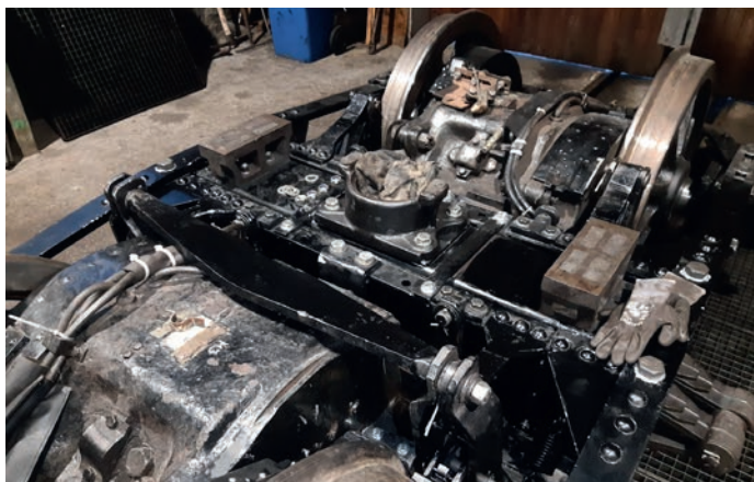
Der neue Schutz der Fahrmotorkabel aus Leder, die aufgearbeitete Tatzlagerschmierung und die montierten Großrad-Lagerkästen. Foto: Stephan Rewitzer
