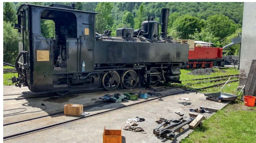
Die U.I mit abgebauten Kuppei und Treibstangen vor dem Heizhaus in Kienberg am 19. Mai 2018. Foto: Thomas G. Schäfer
