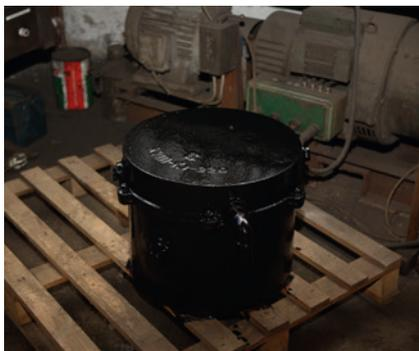
*Der sanierte Bremszylinder mit neuem Rollring innen und Neulack außen steht zum Wiedereinbau bereit.
