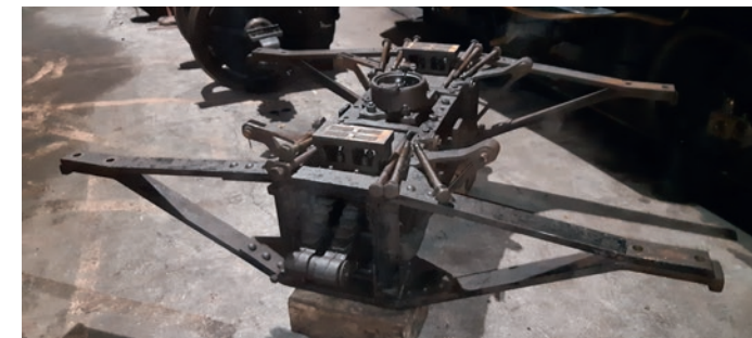
Teilerlegtes Drehgestell der 2093.01.
