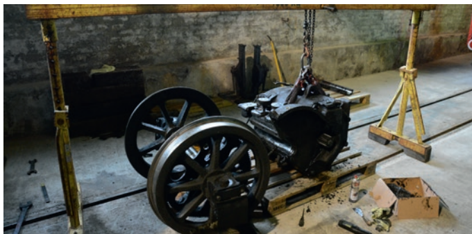
Einer der beiden ausgebundenen Fahrmotoren der E-Lok E I.
