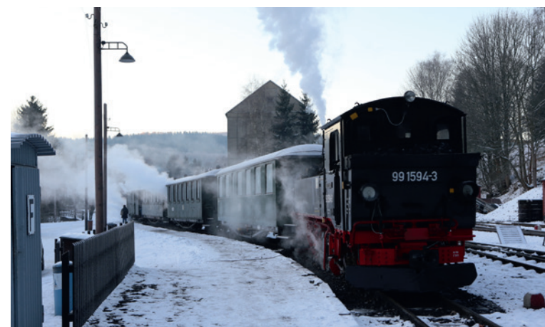
Bei klirrender Kälte steht der Nikolozug zur Abfahrt im Bahnhof Jöhstadt bereit. Die Waggons sind an die Dampfheizung angeschlossen.
