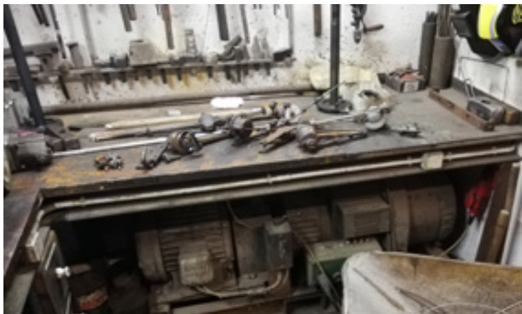
Abgebaute Fahrleitungsteile aus dem Bahnhof Hirschwang werden in der Werkstätte aufgearbeitet. Foto: Reinhard Popp
