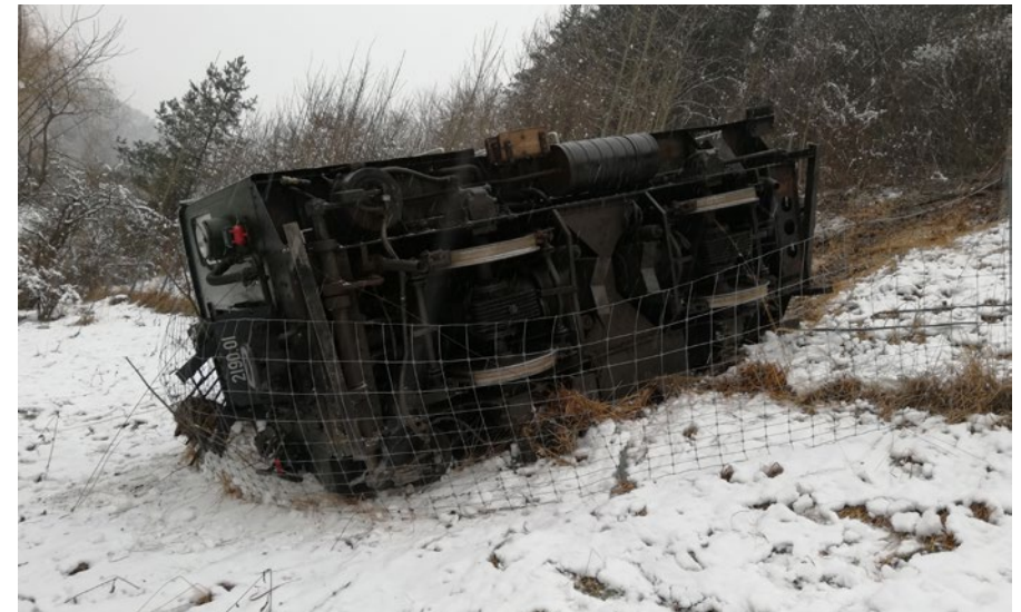
Die Lok ist 1,4 Kilometer talwärts gerollt und in einem Linksbogen entgleist. Ein sehr stabil ausgeführter Wildzaun hat die Lok aufgefangen.
