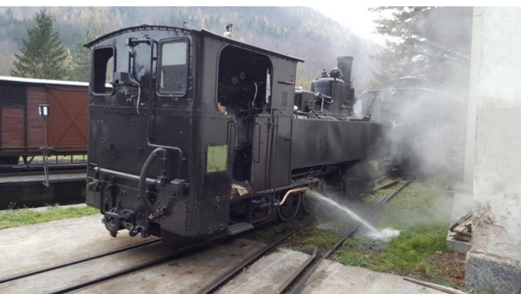
Zum Einwintern wird unter anderem das Wasser vom Kessel abgelassen. Foto: Thomas G. Schäfer
