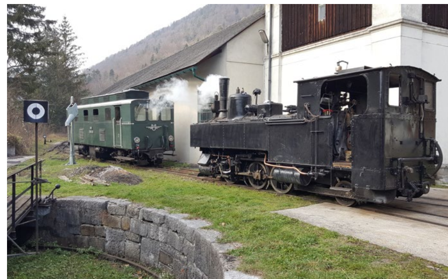
Die U.1 beim Anbrennvorgang am 18. November 2018 im Bereich der Zugförderung vor dem Heizhaus in Kienberg. Als Verschiebefahrzeug diente an diesem Tag die 2093.01. Foto: Thomas G. Schäfer
